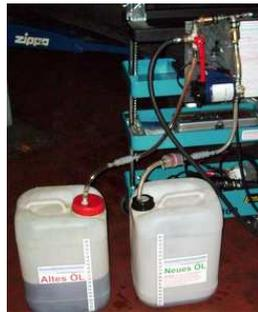
Bei 10,4/12,4 Liter **Altes Öl** umschalten in die **Durchgangsstellung**(Hebel Senkrecht). **4Matic 12L**
