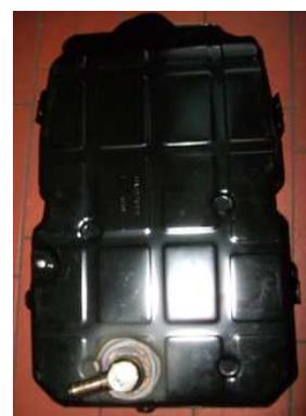
Einbau eines Ölablaßhahnes in die Ölwanne zum Ablassen des Restöles nach dem Leerpumpen auf dem Rollenprüfstand. Somit muß die Ölwanne zum Entleeren nicht abgebaut werden!
