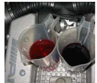
Altes Automatikgetriebeöl aus AMG G55, 2/2006, 25.600km.
