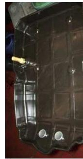
Ölwanne/ Magnete reinigen. Anbau mit **neuen Schrauben!** **4 Nm + 2 x 90° anziehen!**
