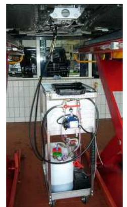
Montageauflage für die Ölwanne zum Wechseln der Ölwannendichtung.
