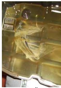
Abbau der Ölwanne. Dafür muß die Ölablasschraube nicht entfernt werden. **Altöl** des Ölfilters+Ölwanne auffangen. Ölfilter+Dichtung wechseln.
