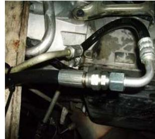
Beim **Neuen Sprinter / Chrysler 300C 3.0 CRD 5G** mit Steckein-satz in der Hohlschraube, das 7-G Stecksystem (der B-Klasse) montieren. **Achtung:** beim 300C V8 geht der Ölstand nur mit dem Ölpeilstab von Chrysler zu messen!
