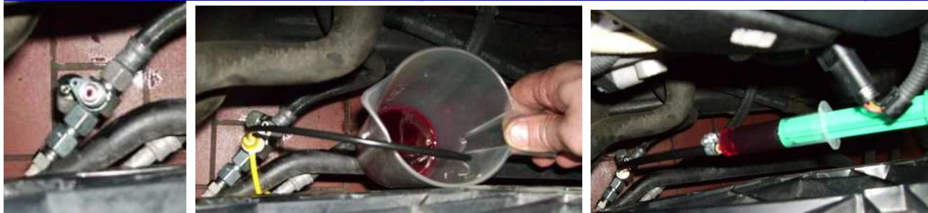
Adapterset für längere 7G Feldversuche: einfaches Ablassen von 160ml Testöl (durch selbst schließendes Kugelventil mit Staubkappe) und wiederbefüllen mit derselben Menge Öl ohne das anschließend der Ölstand gemessen werden muß! **Spezielle Anleitung erhältlich!**
