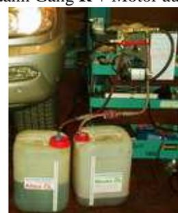
Ölwanne wird bei stehendem Motor mit **5 Liter Neues Öl** befüllt (bis zur **3,5/(2,5)** Liter Marke) durch einschalten der 12V Ölpumpe.
