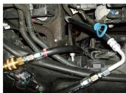
Adapter anschließen z.B. beim W221 unten am Wärmetauscher. Immer die rechte Rücklaufleitung!
