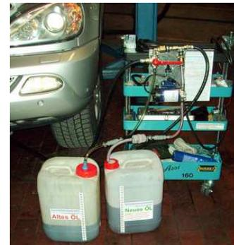
Ölwanne wird bei laufendem Motor + Gang **D (S-Modus)** (funktioniert nur, wenn Alle Antriebsräder blockiert sind) kein Gas geben. Wenn viel Luft kommt 1,5 Liter **Neues Öl** Einpumpen. Dann noch einmal Leerpumpen lassen. Wenn viel Luft kommt in **W/C-Modus** schalten, dann Gang **R** + Motor aus.
