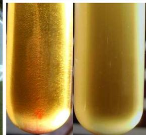
Ist extrem viel Kühlwasser im Automatikgetriebeöl, durch einen defekten Wärmetauscher, muß evtl. zweimal gespült werden. Zuerst mit 600ml Automatikgetriebe reiniger spülen. Sieht das Öl immer noch nicht aus wie neues Öl, siehe Behälter in der Mitte, dann noch einmal mit 400ml Reiniger spülen. Die Ölwanne muß aber auch beim zweiten Spülen abgebaut werden und der Ölfilter entleert werden!
