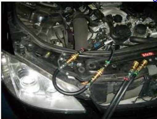
Während des Testes überbrücken der eingebauten Adapter. Dank Schnellverschlußadaptersystem kann innerhalb von Sekunden das Spülsystem wieder dazwischengeschaltet werden und schon innerhalb weniger Minuten auf dem Rollenprüfstand komplett auf ein anderes ATF-Öl umgeölt werden.
