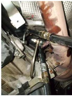
W211 5-Gang am Getriebe angeschlossen, oder wenn möglich vorne am Wärmetauscher.
