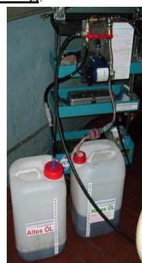
Ölwanne wird bei laufendem Motor +Gang D (S-Modus)(funktioniert nur, wenn Alle Antriebsräder blockiert sind)kein Gas geben, von ca...Wenn viel Luft kommt in W/C-Modus schalten, dann Gang R + Motor aus.
