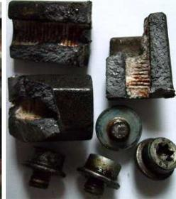
Bei den älteren 722.6 Getrieben der Benziner (diese haben keine Kunststoffabdeckung unten) korrodieren die Schrauben der Ölwanne in den Aluabstandhaltern total fest. Beim Öffnen werden die Schraubenköpfe abgedreht. Am Besten, man spaltet mit einem Meißel die Aluabstandstücke auseinander. Dann wird mit zwei gekonterten Muttern die restliche Schraube ganz einfach herausgedreht. So geht es am schnellsten. **Wegen Gehäusebruchgefahr geht das nicht bei der Schraube am EGS-Stecker!** Notfalls Auspuff
