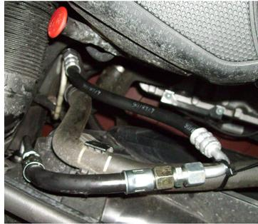
Adapter am W164, ML 320CDI zur Probefahrt mit dem Reiniger, **überbrückt!**
