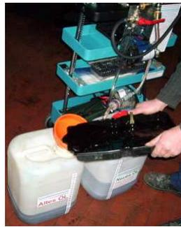
Restölvanninhalt (**0,5-1,0** Liter **Altes Öl**) in den Kanister **Altes Öl** einfüllen (incl. der **Altölm**enge des Ölfilters) Damit kann die ganze **Altölm**enge festgestellt werden. (Ablaßbahn der Servicestation kurz öffnen)
