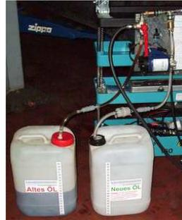
12V Pumpe ausschalten, wenn alles **Neue Öl** eingepumpt ist. Ölwechsel fertig! **10,5/12,5** Liter **Neues Öl** eingepumpt. **10,4/12,4** Liter (incl. **400-600ml Vorreiniger**) **Altes Öl** abgepumpt.
