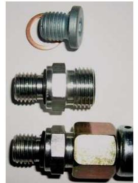
Linkes Bild: MB Original 7G Adapter zum Befüllen über die Ölwanne mit einer Zapfanlage. Preis in Deutschland ca. 100€.
