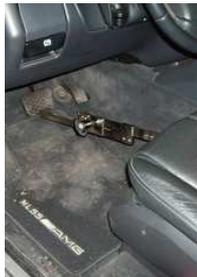
Pedalbremse bei Allrad/Front-Antrieb.
