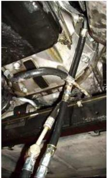
Adapter W163, ML 400CDI V8, Adapter AMG ML55. Dazu muß für den ML V6/8 eine andere Hohlschraube(im Bild oben)verwendet werden.
