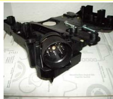
Elektroteil mit magnetischen Drehzahlfühlern.
