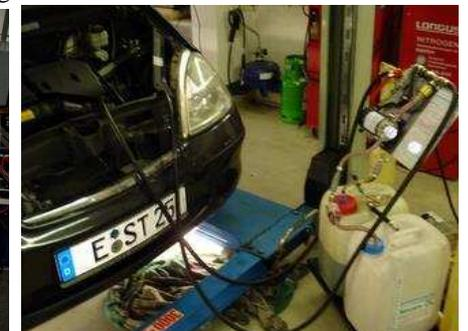
Angeschlossen an Vaneo + an A-Klasse W168, beide Ölwechsellmenge ca. 7 Liter.
