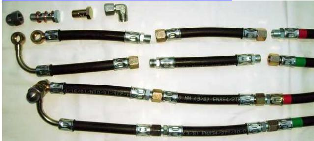
Hohlschraubenanschluß links, Wärmetauscheranschluß W211 Mitte, Wärmetauscheranschluß W210/W203 usw. rechts. **Rot linker** Schlauch, **Grün rechter** Schlauch!
