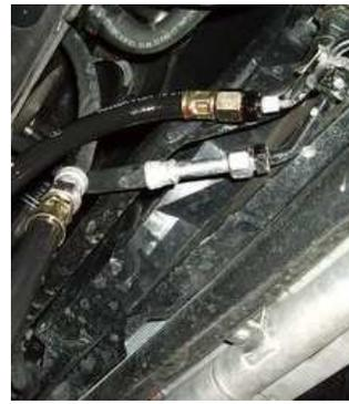
W211, 7-Gang, z.B. am Wärmetauscher.
