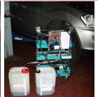
Ölwanne wird bei laufendem Motor, blockierten Antriebsrädern, Gang **D (S-Modus)**, kein Gas geben, leer gepumpt bis Luft kommt (ca. **5-6,4 Liter Altes Öl**). **Funktioniert nur, wenn sich kein Antriebsrad dreht!** Wenn viel Luft kommt in **M/C-Modus** schalten, dann Gang **R** + Motor aus. (Evtl. danach: Hat der Wandler eine Ablaßschraube kann das Öl zusätzlich in den Kanister **Altes Öl** abgelassen werden). **Ablausschraube: A0019901117**
