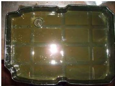
Normale runde Messingspäne in der Ölwanne. Magnet wird nachgerüstet.
