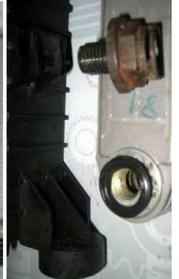
Undichter Valeo Wärmetauscher aus W211, 270CDI aufgesägt. Die undichten Gummidichtringe sind der Verursacher der Glykolverseuchung!
