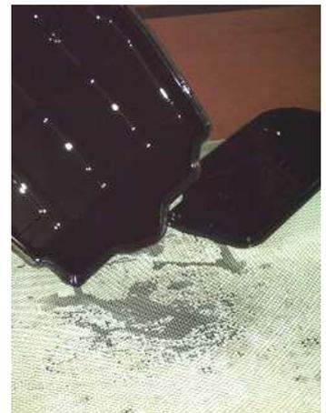
Ölwanne für Adapter/ Werkzeug/ Öl etc. mit Abführen des Restöles in den Altölkkanister! Altöl auskippen in die obere Ölwanne mit Sieb zum Spritzschutz. Das Altöl läuft dann automatisch in den Kanister. Altes Öl unten in der Servicestation. So einfach ist das! Unten Platz für die Kanister, den Reiniger, Batterie und Spraydosen etc..
