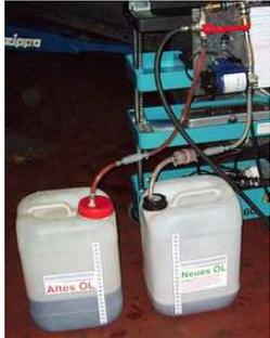
Nach 15 Sek in (**S-Modus**)schalten und dann in **Gang D** schalten! Die 12V Ölpumpe läuft weiter!
