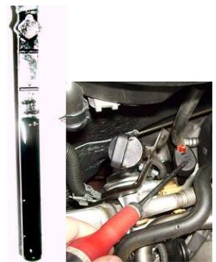
Öl-Wechsel/Spülen: Motor einschalten+**Gang R (W/C-Modus)**, **Alle** Antriebsräder blockiert, kein Gas geben. Nach 15 Sek in **(S-Modus)** schalten und dann in Gang **D** schalten! Die 12V Ölpumpe läuft weiter!
