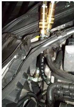
AMG SL55 W230 oben am Wärmetauscher mit Winkeladapter. Funktioniert so auch beim W220/W230!
