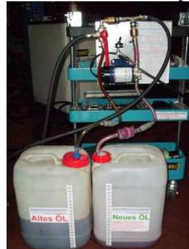
**oder** Umschalten in die **Durchgangsstellung** bei Erreichen der **10,4 Liter Altöl** (incl. 400 Vorreiniger) bei **großem Wandler**.
