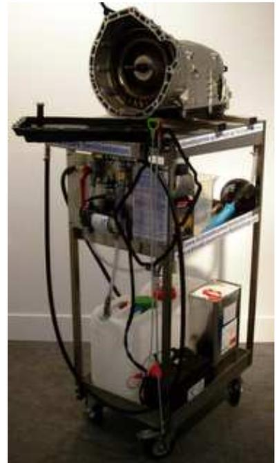
Zusatzwanne für Werkzeug/ Schrauben etc., Aufhänger für die beiden Schläuche mit Hydraulik Schnellverschlusskupplungen. Aufhänger für 2 Ölpeilstäbe, Ölwannendichtung etc.. 2 Absperrhähne für die 2 Ölwannen. Auf Sonderwunsch eine Aluwanne (zum Auffangen des Restöles) für den liegenden Transport.
