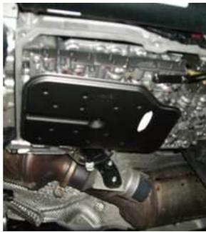
Ölwanne abbauen ohne das die Ölablaßschraube entfernt werden muß. Ölfilter erneuern. (Bei **4Matic**, Öl aus dem Verteilergetriebe ablassen, **außer ML/ GL/ R-Klasse**).
