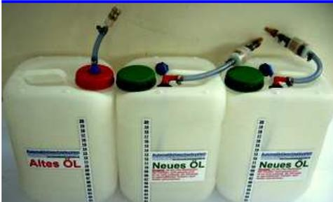
**Kanister Neues Öl mit neuem stabilerem Saugrohr. Hier ist nun die Befüllung ohne Herausnahme des Saugrohres möglich!**
