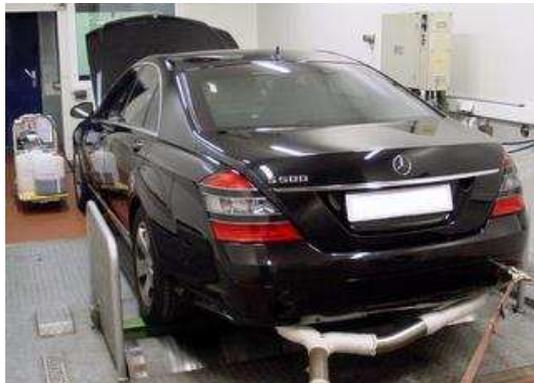
Vollständige Umölung auf dem Prüfstand zum Testen der Eigenschaften von verschiedenen ATF-Ölen. Für vergleichbare Messergebnisse darf der W221, S500 7-Gang nicht vom Prüfstand!
