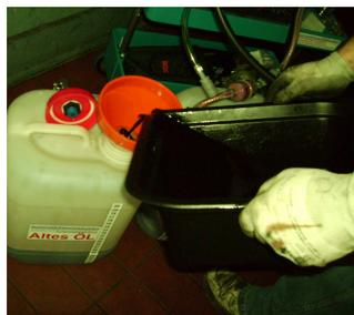
Nun sind ca. **8/(7)** Liter **Altöl** im Kanister. **Neues Öl** ca. bei **8/(7)** Liter Marke. (Evtl. danach: Hat der Wandler eine Ablaß-Schraube, kann das Öl zusätzlich in den Kanister **Altes Öl** abgelassen werden).
