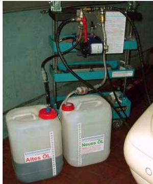
Restliches **Neues Öl** einpumpen. 12V Ölpumpe ausschalten. **9 Liter Neues Öl** eingepumpt bei **kleinem Wandler**. Ölstandskontrolle ca. **55°**. Korrektur mit dem System,
