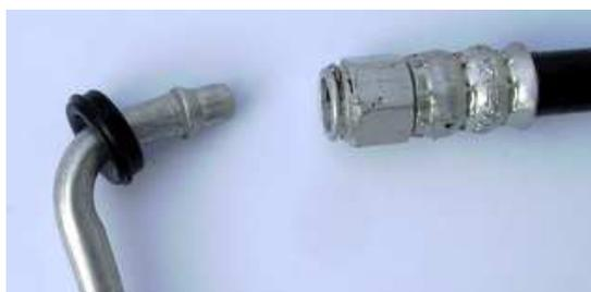
Dann die Leitung an beiden Seiten, wie im Bild abgebildet, absägen. Innen und außen die Leitung gut entgraten und mit Druckluft die Späne entfernen. Die Mutter und den Schneidring wie im Bild in Position bringen. Dann den beidseitigen Stutzen ansetzen und mit der Mutter verbinden. Wenn die Mutter anliegt, darf diese nur noch genau um 360 Grad festgeschraubt werden, damit der Schneidring richtig dicht sitzt.
