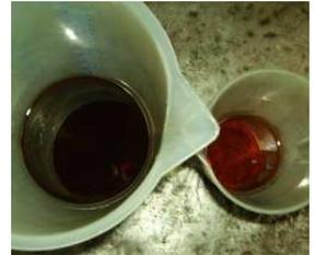
Zu Testzwecken wurde hier zuerst nur mit Öl ohne Reiniger gespült. Dann Reiniger eingepumpt. Nach **15 min** ist das **Neue Öl** wieder **schwarz** (linker Becher in Bildern). **400-600ml Vorreiniger** **Altes Öl** abgepumpt.
