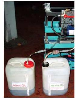
Mit der 12 V Pumpe die Ölwanne(Motor aus) mit **4** Liter **Neues Öl** (bei **6,5** Liter Marke) befüllen. Dann Motor starten, Gang **R(M/C-Modus)**. Alle Antriebsräder blockiert, kein Gas geben.
