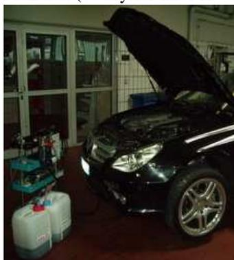
Adapter am Rücklauf anschließen bzw. System wird in den Rücklauf (bei MB immer in Fahrtrichtung rechts) in Reihe eingebaut, siehe Beschreibung+Zeichnung oben.
