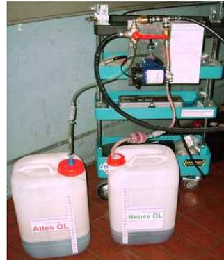
Öl-Wechsel/Spülen: Motor einschalten+**Gang R (W/C-Modus)**. **Alle** Antriebsräder blockiert, kein Gas geben. Nach 15 Sek in (**S-Modus**) schalten und dann in **Gang D** schalten! Die 12V Ölpumpe läuft weiter!
