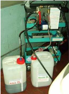
Umschalten in die **Durchgangsstellung** bei Erreichen der **9,4 Liter Altöl** (incl. 400 ml Vorreiniger), bei **kleinem Wandler**.
