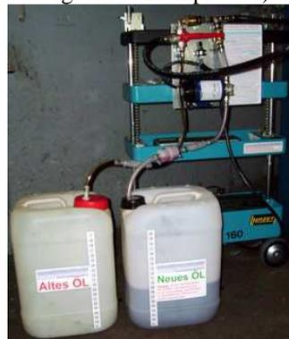
Start des Wechsels mit z.B. 9 Liter Neues Öl in der Wechselstellung z.B. W210 Vierzylinder mit kleinem Wandler (Hebel waagrecht). (722.7/CVT-Getriebe: 7L Öl). Bei Adaption an der 17/19mm
