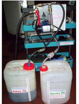
**oder** Restliches **Neues Öl** einpumpen. 12V Ölpumpe ausschalten. **10 Liter Neues Öl** eingepumpt bei **großem Wandler**. Ölstandskontrolle ca. **55°**. Korrektur mit dem System,
