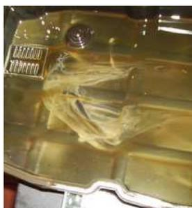
Abbau der Ölwanne. Dafür muß die Ölablaßschraube nicht entfernt werden. **Altöl** des Ölfilters+Ölwanne auffangen. Ölfilter+Dichtung wechseln. **0,3-0,5** Liter Rest **Altöl** aus der Ölwanne + Ölfilter in den Kanister (**Ablaßhahn der Service-station kurz öffnen**)
