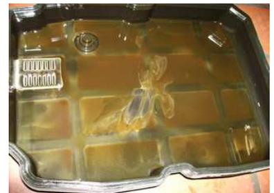
MB-Glykoltest für z.B. W203, W209, W211 **OK** bis **100 mg pro Liter Öl**. Über 100mg pro Liter Öl, Kühler tauschen und Getriebe spülen. Wenn durch die Spülung keine Besserung empfiehlt Daimler den Tausch des Wandlers!!! Schlamm/ Abrieb in der Ölwanne.
