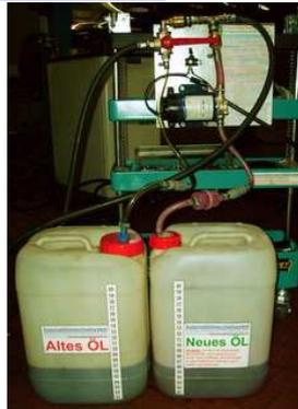
**oder** Ölwanne wird bei stehendem Motor mit **4 Liter Neues Öl** befüllt (**6 Liter Marke bei großem Wandler**.) durch einschalten der 12V Ölpumpe.
