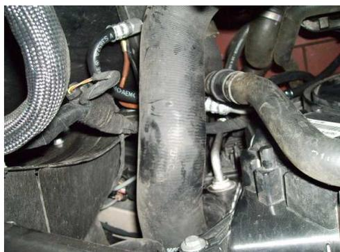
Adapter am Wärmetauscheranschluß anschließen (rechte Rücklaufleitung) z.B. beim W251/ W164 oben am Wärmetauscher.
