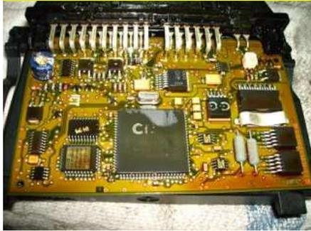
Veröltes EGS-Steuergerät von innen, ab W211 gab es Ölsperren im Kabelbaum!
