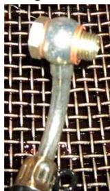
2 Dichtringe unterlegen (da sonst undicht)
