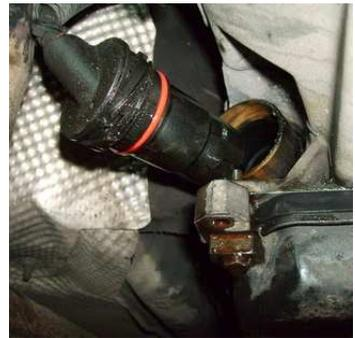
Ölwanne montieren (**8 Nm**). EGS-Stecker abziehen und auf interne Undichtigkeit kontrollieren, bzw. gegebenenfalls erneuern (**2,5Nm**)!
