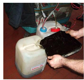
**0,3-0,5 Liter Rest Altöl** aus der Ölwanne+Ölfilter in den Kanister **Altes Öl** einfüllen (Abfahrbahn der Servicestation kurz öffnen). Falls kein **Magnet** vorhanden ist: Ohne Magnet können sich Eisenspäne auf den magnetischen Drehzahlfühlern festsetzen Die Folge kann ein Getriebemotlauf sein(Drehzahlvergleich unplausibel). Dann abbauen+Drehzahlfühler von Metallspänen säubern!
