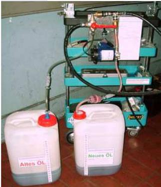
Ölwanne wird bei stehendem Motor mit **4 Liter Neues Öl** befüllt (**5 Liter Marke bei kleinem Wandler**.) durch einschalten der 12V Ölpumpe.
